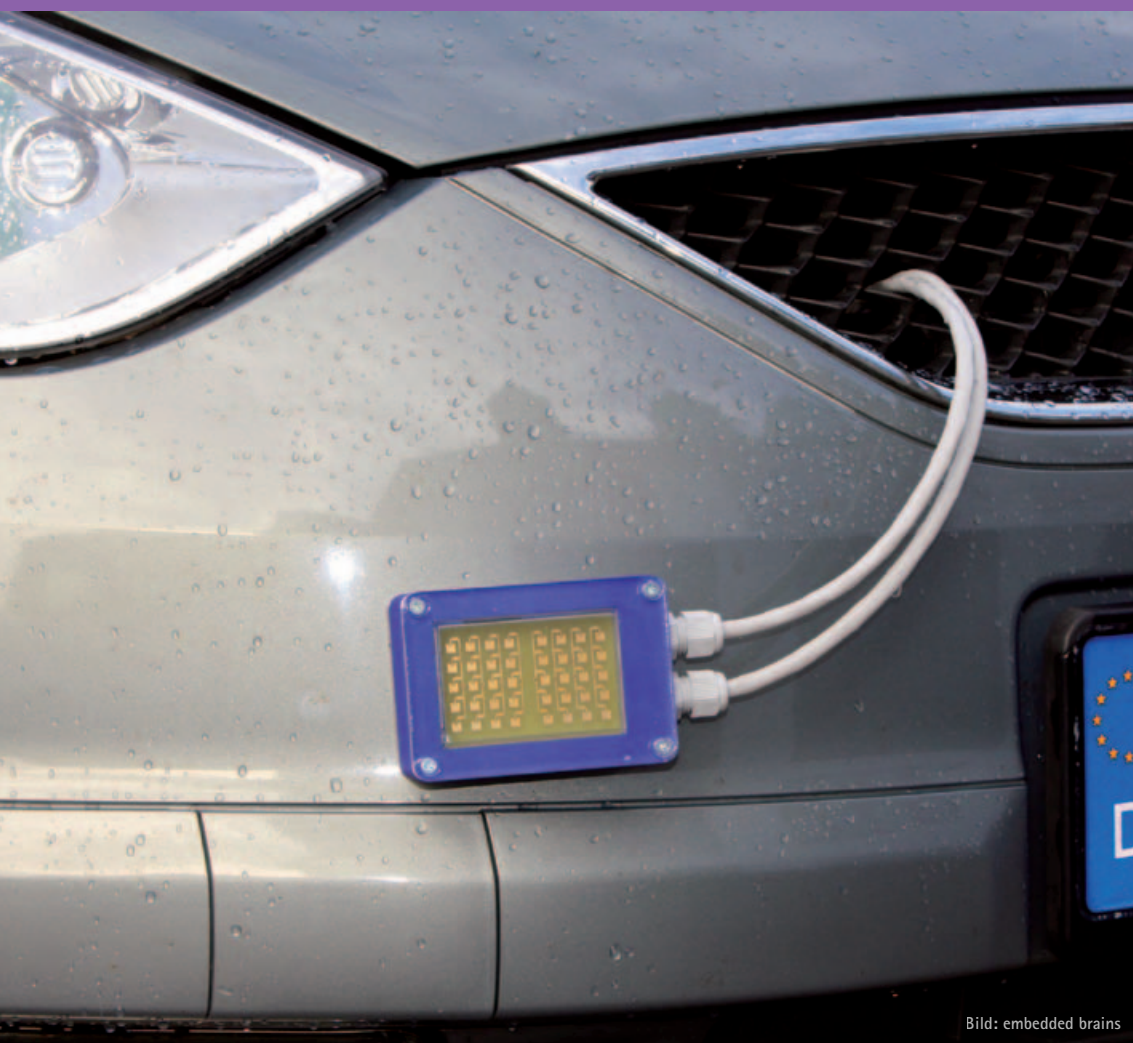
Ein Sensor-Array zur Aufzeichnung von Test-Radardaten
