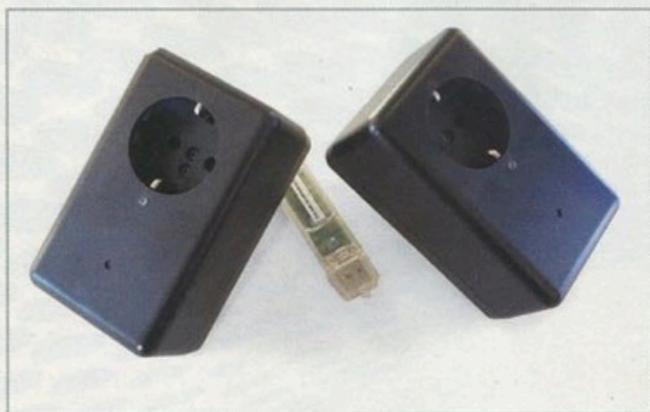
Für das Projekt „mySmartGrid“ entwickelte Embedded Brains einen Wireless-Stecker mit Strommesser für die Hausautomation.
